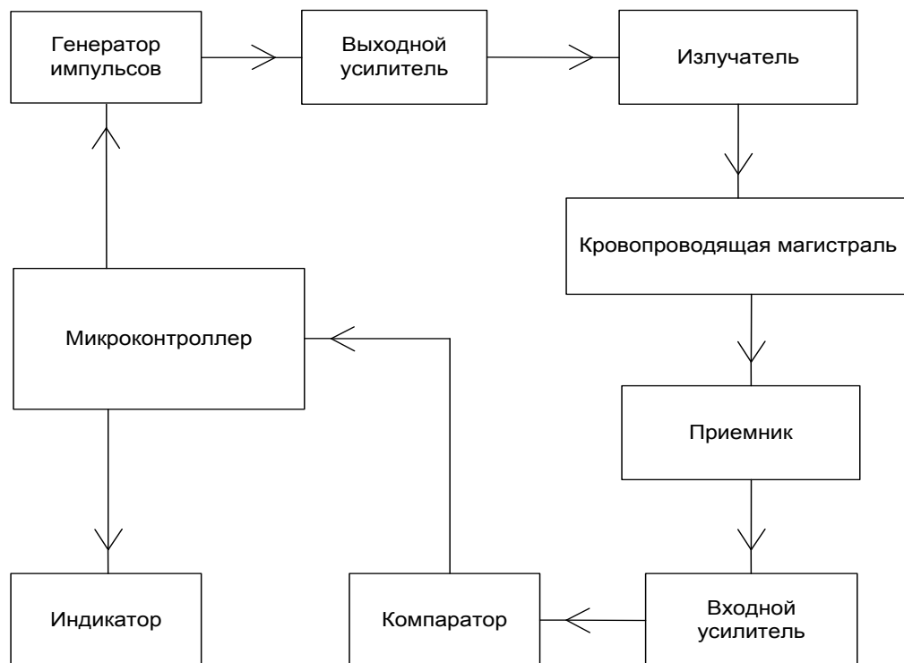
Рис.1. - Структурная схема ультразвукового детектора воздуха
