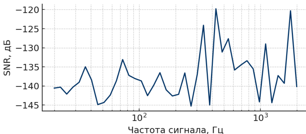
Рис.5. Зависимость отношения сигнал/шум (SNR) от частоты полезного сигнала при T = 300K
