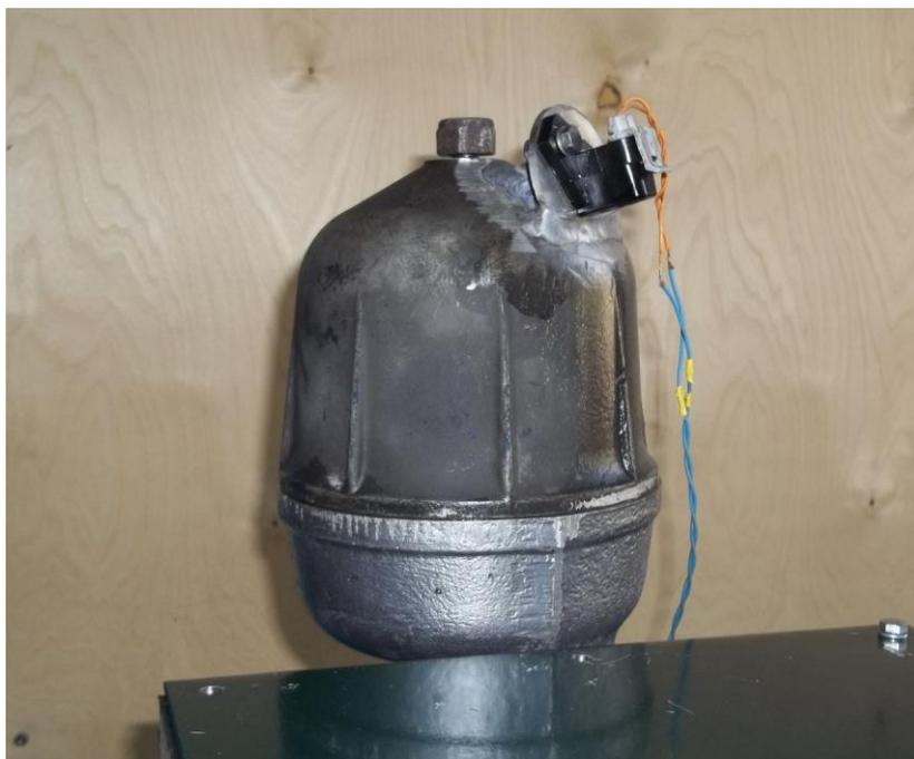
Рис. 3. – Центробежный фильтр двигателя ЯМЗ с датчиком
