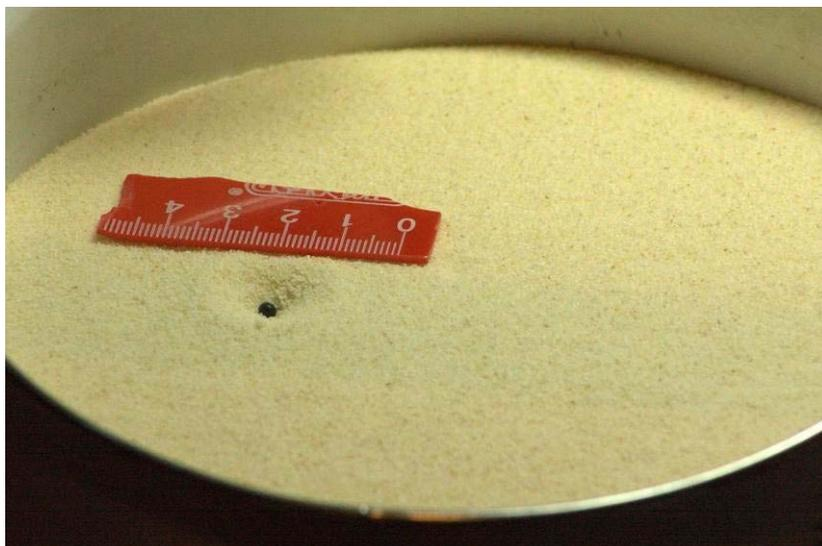
Рис. 3 – Результат столкновения при скорости 5 м/с
