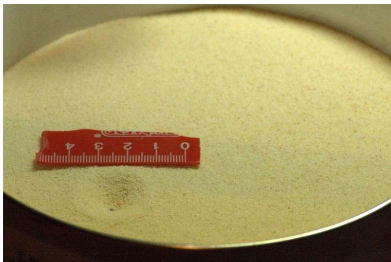
Рис. 4 – Результат столкновения при скорости 10 м/с
