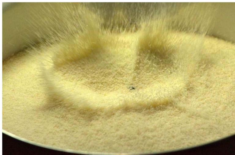
Рис. 5 – Результат столкновения при скорости 10 м/с
