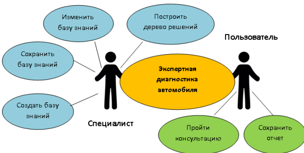
Рисунок – UML-диаграмма вариантов использования экспертной системы
