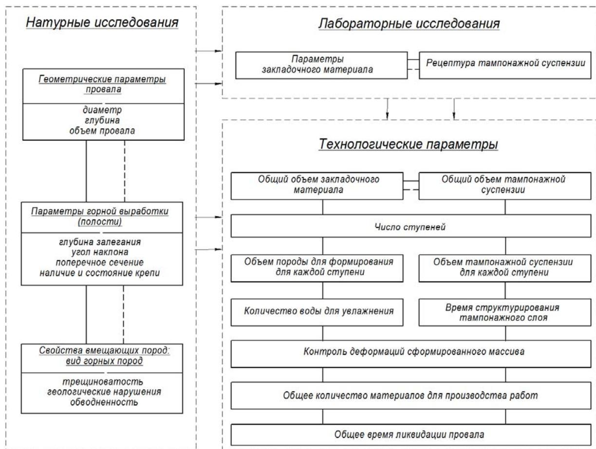
Рис. 1 – Обобщенная методика определения параметров способа ликвидации провалов земной поверхности
