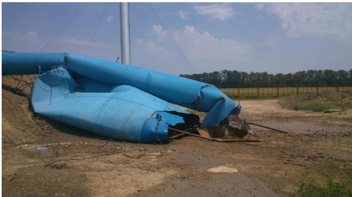
Рис.6. Обрушение башни Рожновского вследствие потери местной устойчивости стенки
