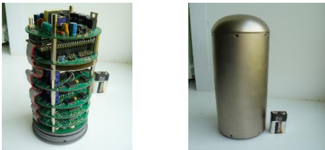
Рис. 1. – Внешний вид малогабаритного multifunctional гидролокационного комплекса для подводного буксируемого аппарата
