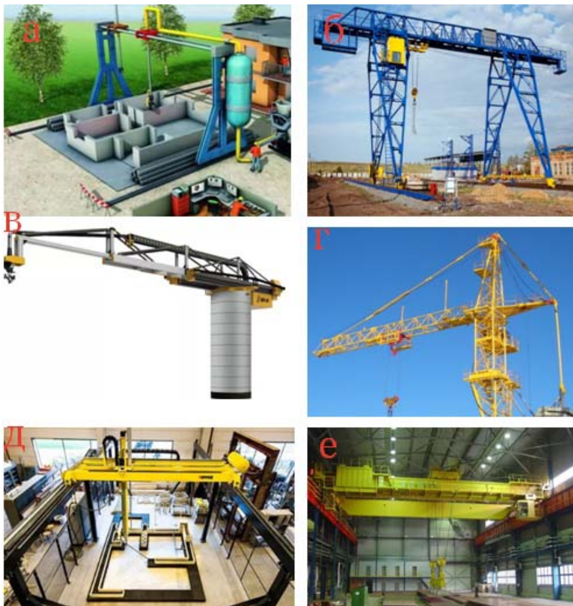
Рис.2. – Внешнее сходство современных строительных принтеров и строительных кранов: а – принтер WinSun; б – козловой кран; в – принтер APIS COR; г – башенный кран; д – принтер ZhuoDa group; е – мостовой кран
