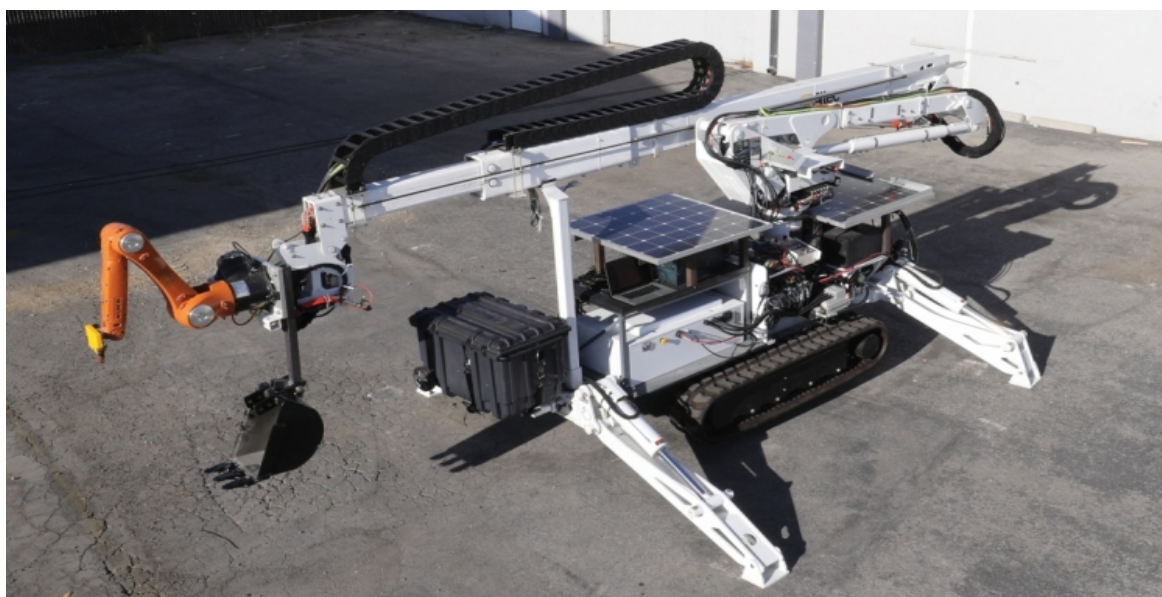
Рис.3. – Внешний вид мобильного строительного 3D-принтера DCP, MIT (США) [14]
