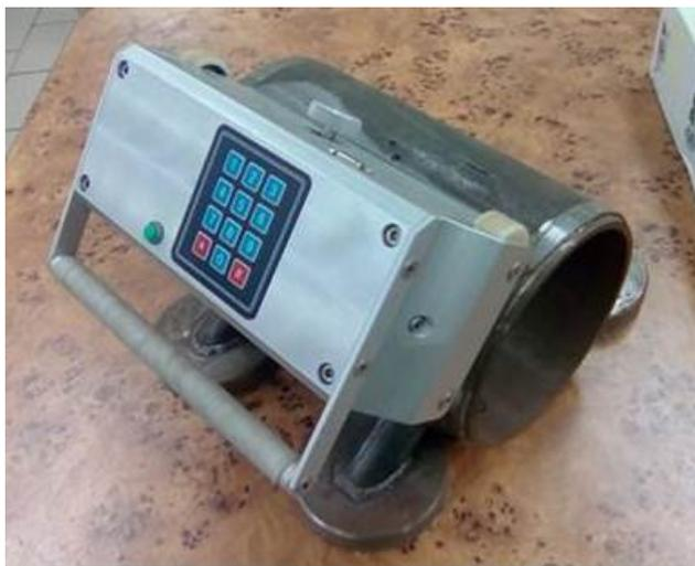
Рис. 5. – Пример самофиксации прибора на теле трубы из ферромагнитного материала
