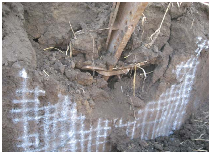
Рис. 3. – Область разрыхления для формы системы деформаторов в опыте №2 (рис. 1.2.б)
