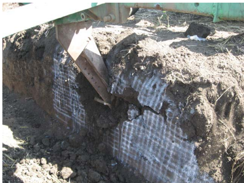
Рис. 5. – Процесс пенетрации и разрыхления стойкой ГНЧ-0,6У
