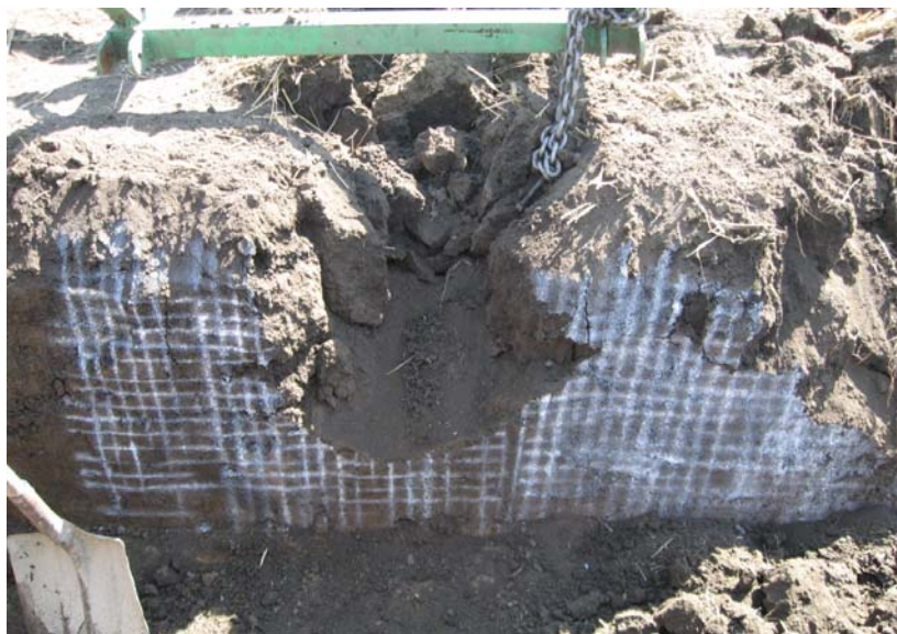
Рис. 4. – Область разрыхления для формы системы деформаторов в опыте №3 (рис. 1.3.б)
