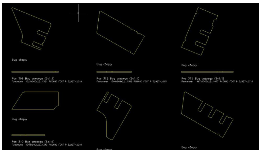
Рис. 5. - Детализовка секции наклонного борта опорного блока МНС
