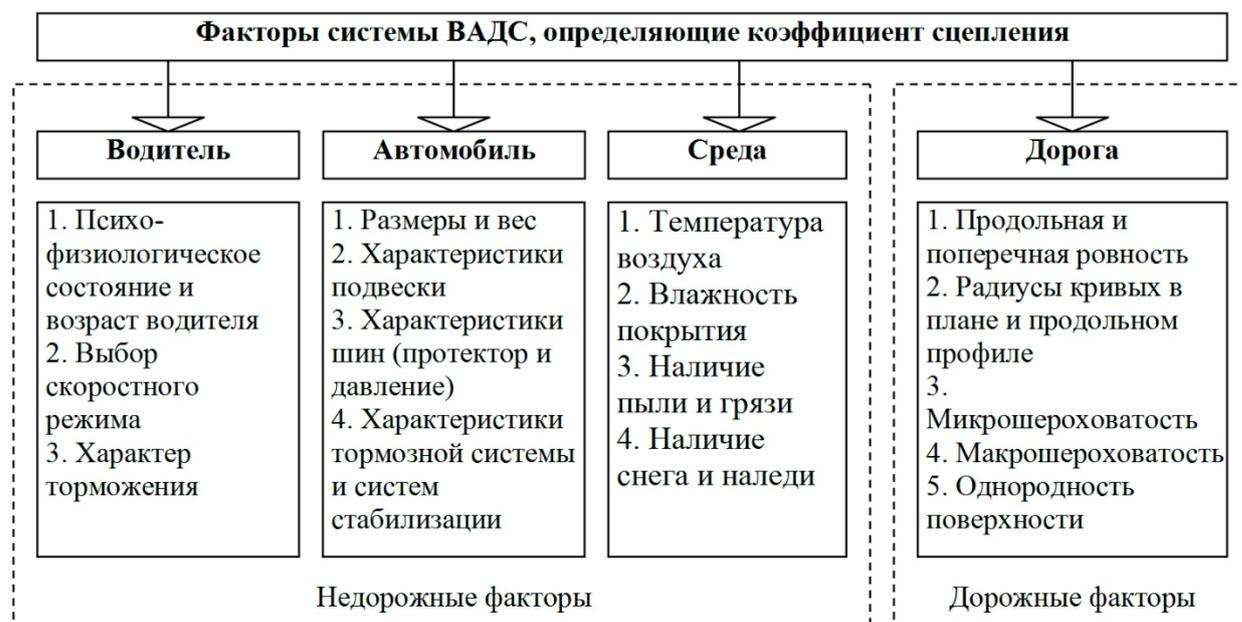
Рис. 2. – Факторы ВАДС, определяющие коэффициент сцепления с покрытием автомобильной дороги
