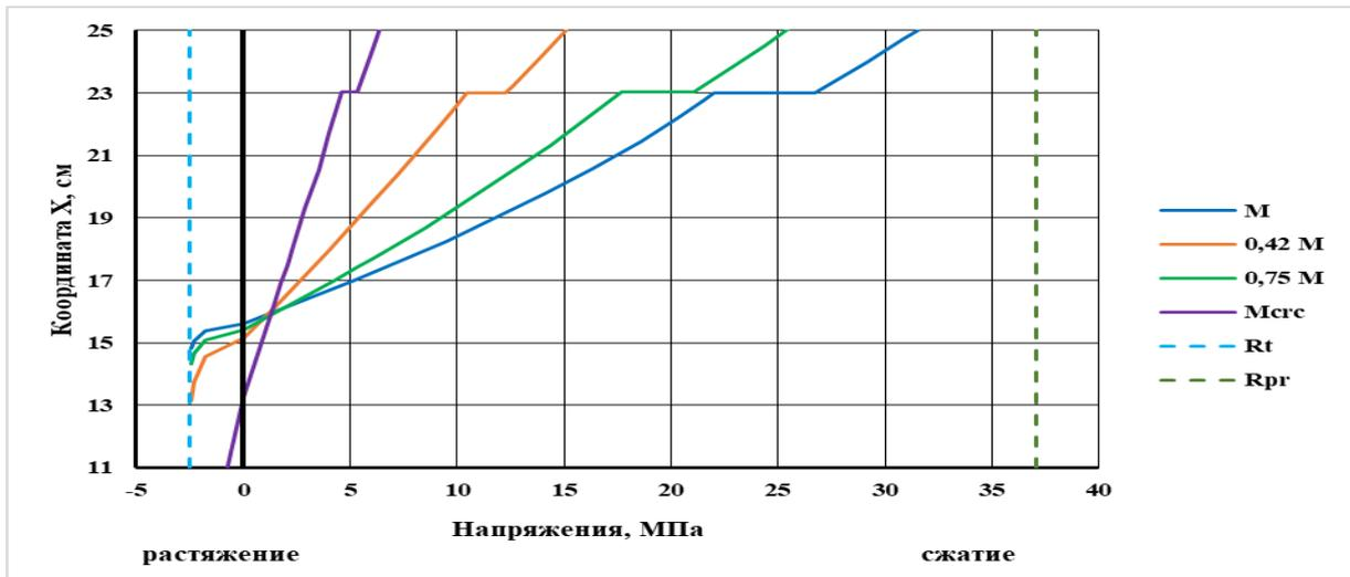
Рис. 6. – Эпюры нормальных напряжений по сечению двухслойной балки со слоем БКС в сжатой зоне 20 мм
