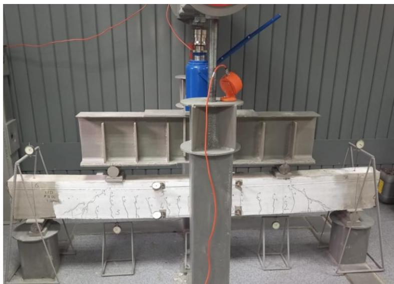
Рис. 1. – Испытание железобетонной балки на изгиб по ГОСТ 8829-2018
