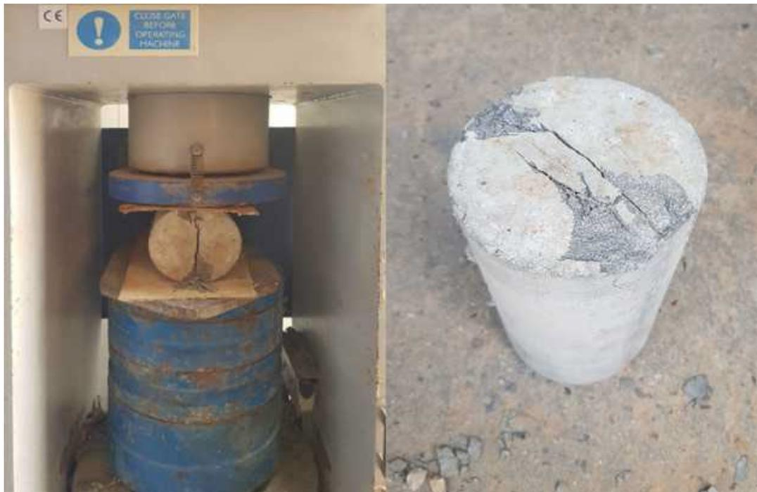
Рисунок 3. – Испытание на раскалывание
