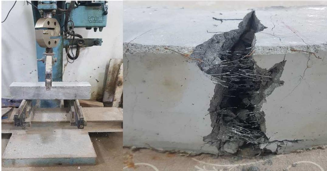
Рисунок 2. – Испытание на изгиб
