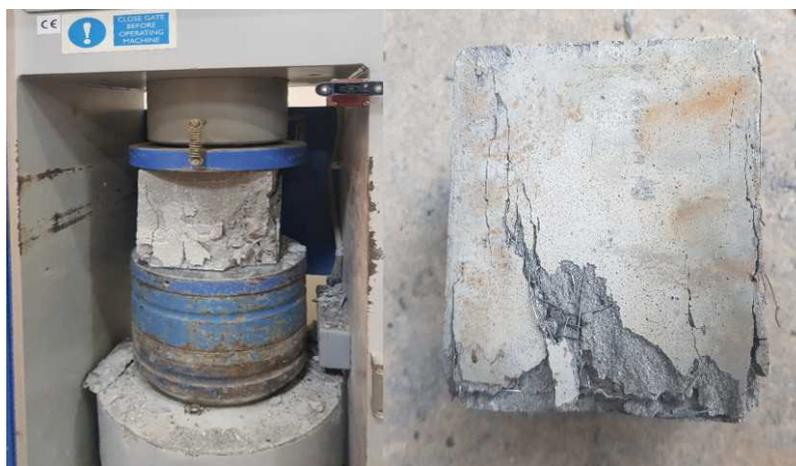
Рисунок 1 – Испытание на сжатие
