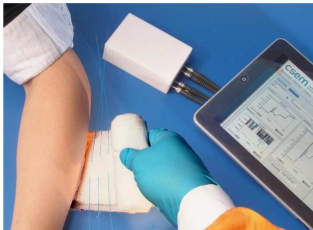
Рис. 1. – Прототип тканой сенсорной системы
