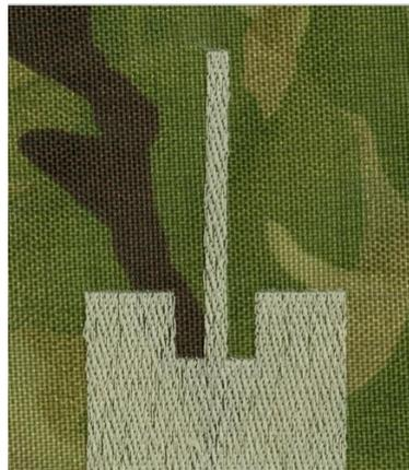
Рис. 3. – Антенна на тканой основе
