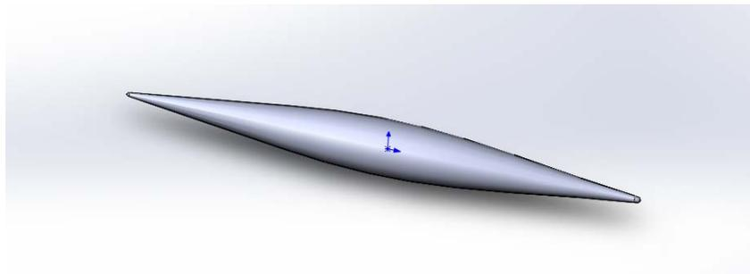
Рис. 1 – Форма оптимального тела с минимальным аэродинамическим сопротивлением потоку газа
