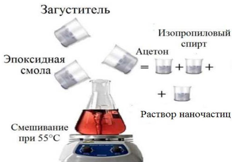
Рис. 3. – Процесс приготовления фантомов ткани, содержащих наночастицы
