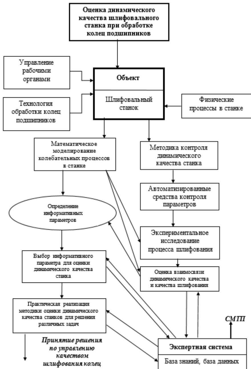
Рис. 1. Методическое обеспечение для практической реализации управления качеством колец подшипников
