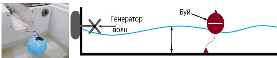
Рис. 3. – Принципиальная схема экспериментальной установки
