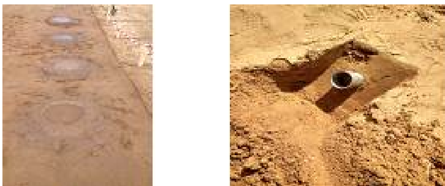
Рис. 5. – Увлажнение мест закладки датчика и отбор проб грунта для определения его влажности и плотности
