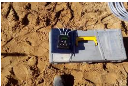
Рис. 3. – Опрос значений датчиков влажности мобильным переносным считывателем данных
