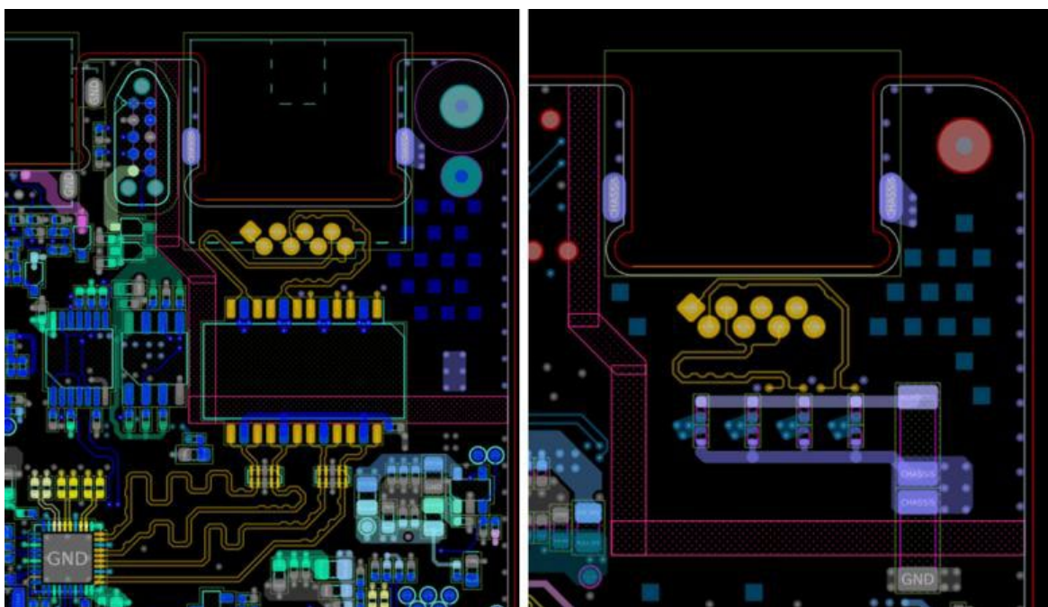
Рис.4. – Внешний трансформатор Ethernet разъема RJ-45.
