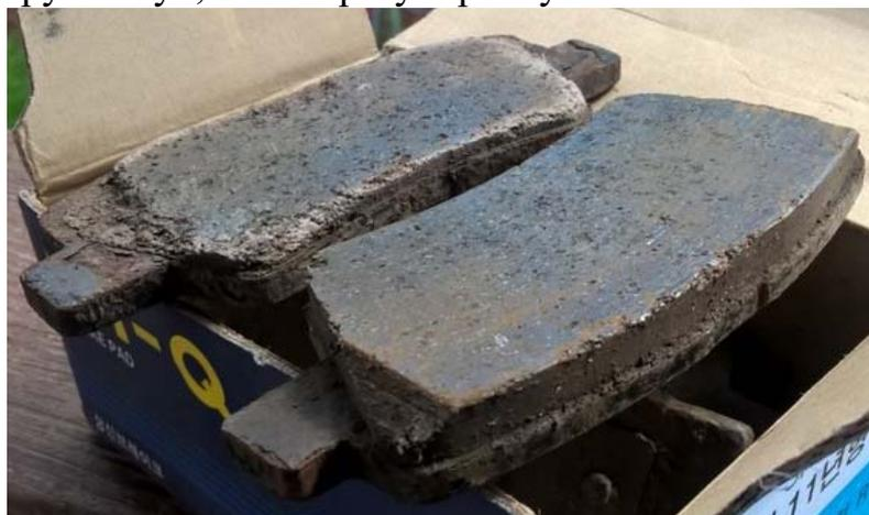
Рисунок 2 – Внешние колодки задней оси с неравномерным износом вследствие проблемы в гидравлике тормозной системы
