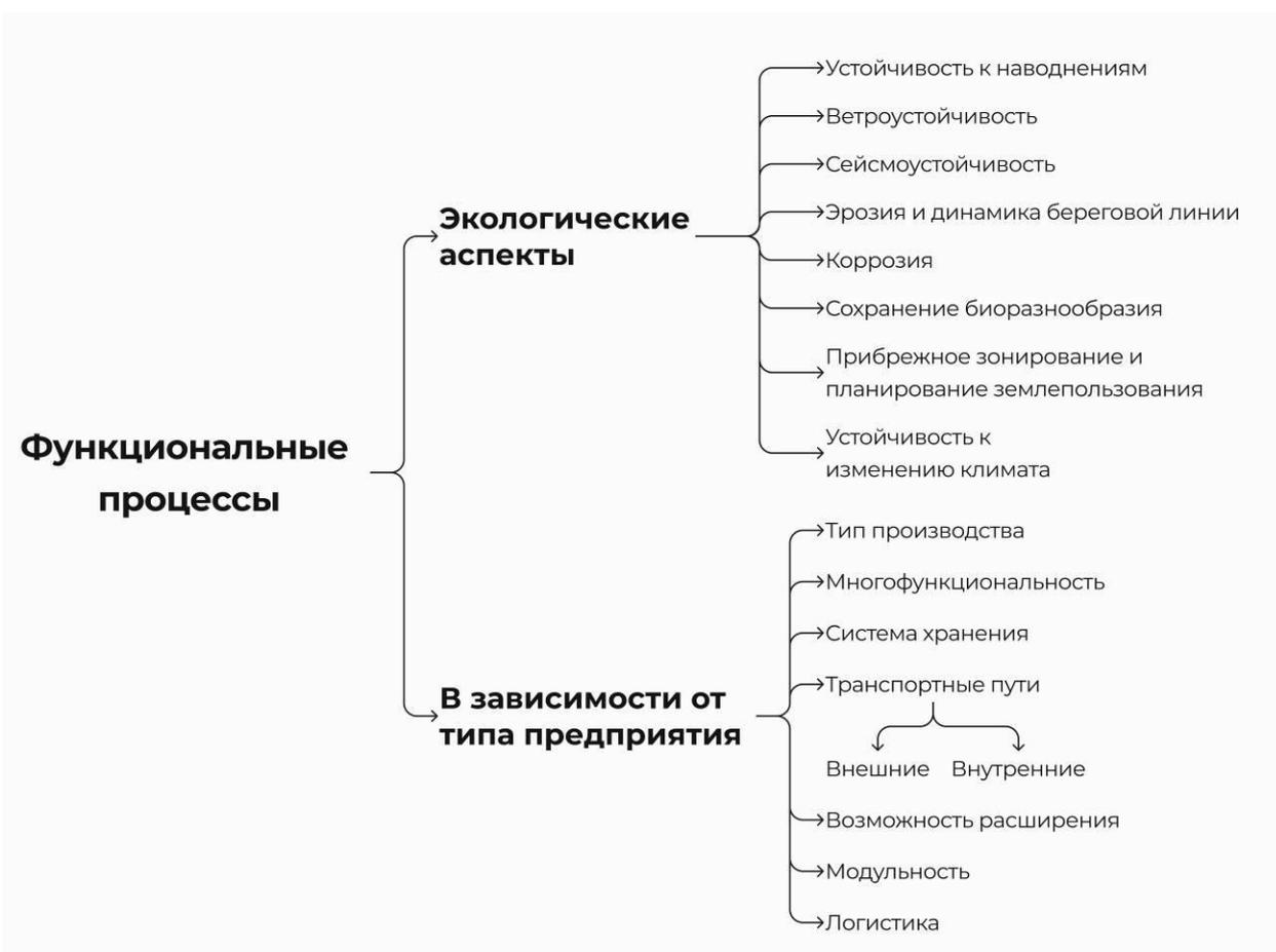
Рис 1. – Схема функциональных процессов, влияющих на объемно-планировочное решение промышленных зданий на прибрежных территориях [Изображение автора].
