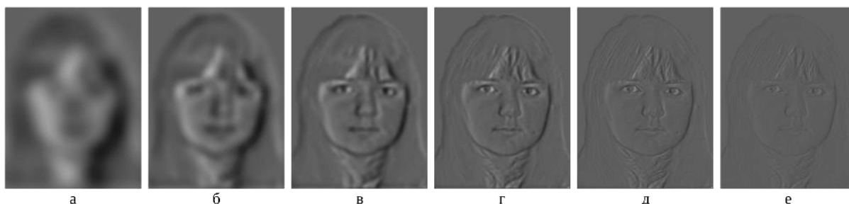
Рис. 2. Объединённые по всем ориентациям выходы фильтров Габора с различными частотными настройками: а – для частоты 4 цикла/изображение, б – 8, в – 16, г – 32, д – 64, е – 128 циклов/изображение.
