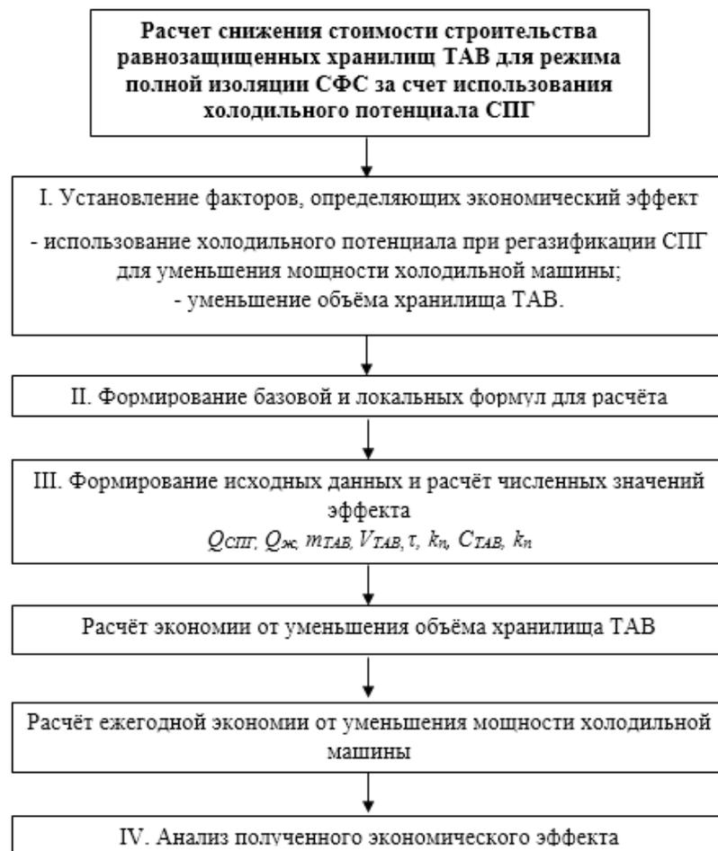
Рис. 1. Блок-схема расчета снижения стоимости строительства равнозащищенных хранилищ ТАВ для режима полной изоляции СФС за счет использования холодильного потенциала СПГ.
