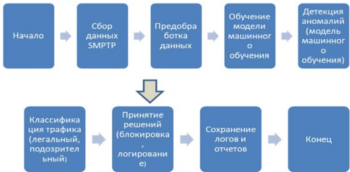
Рис. 2. Процесс анализа и обработки данных трафика SMTP с использованием методов машинного обучения
