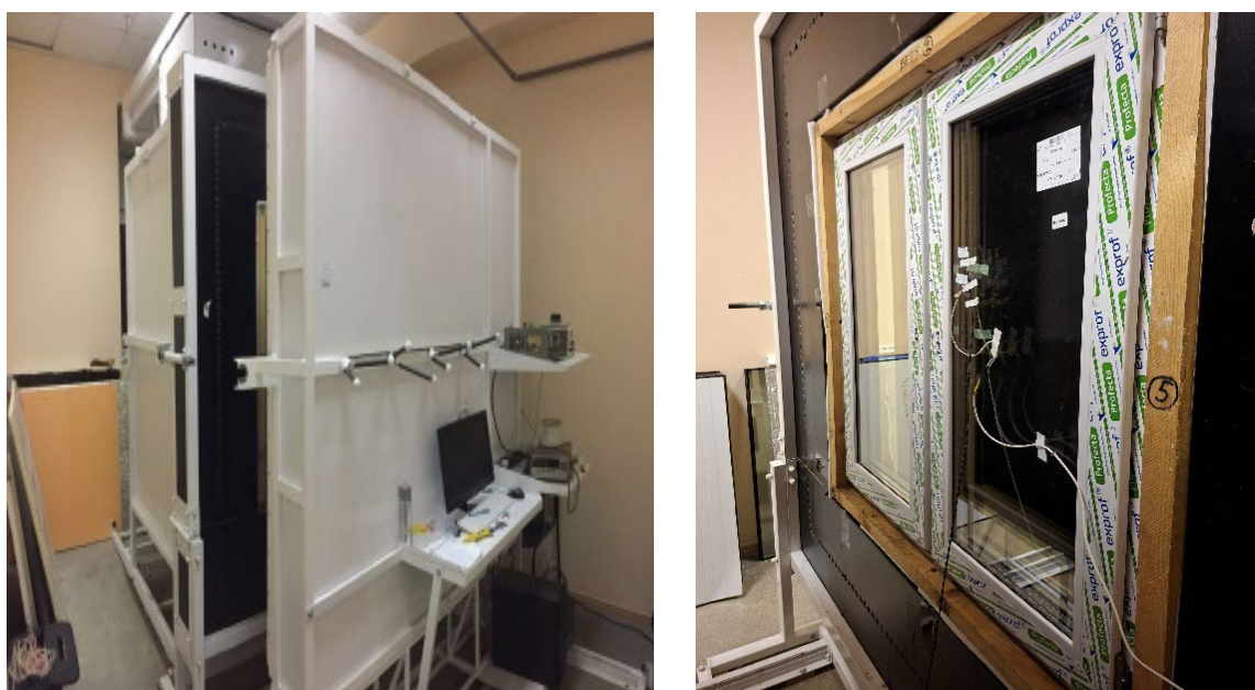
Рис. 2. – Климатическая камера «хот-боксе» для определения коэффициента теплопередаче
