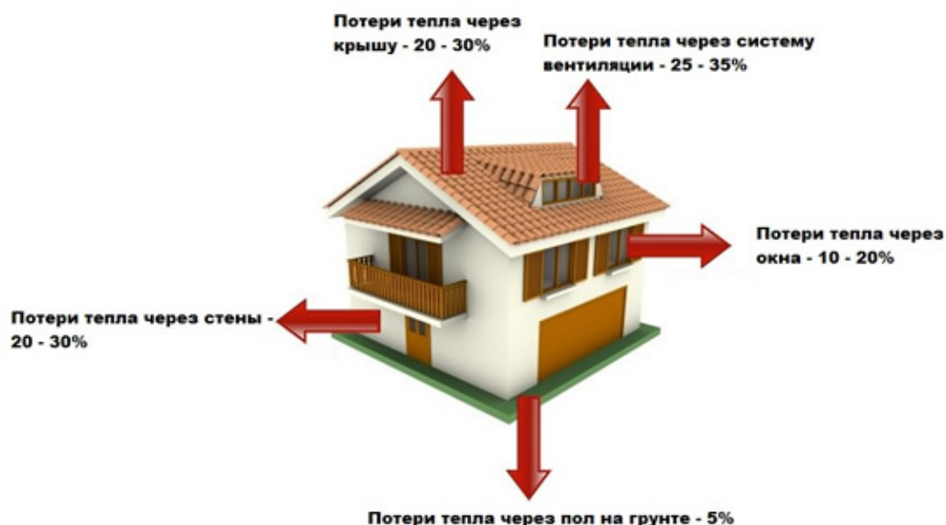
Рис.1 «Теплопотери через ограждающие конструкции»
