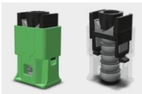
Рис. 3 - Поглощающий аппарат АПФК-110 с полимерными элементами
