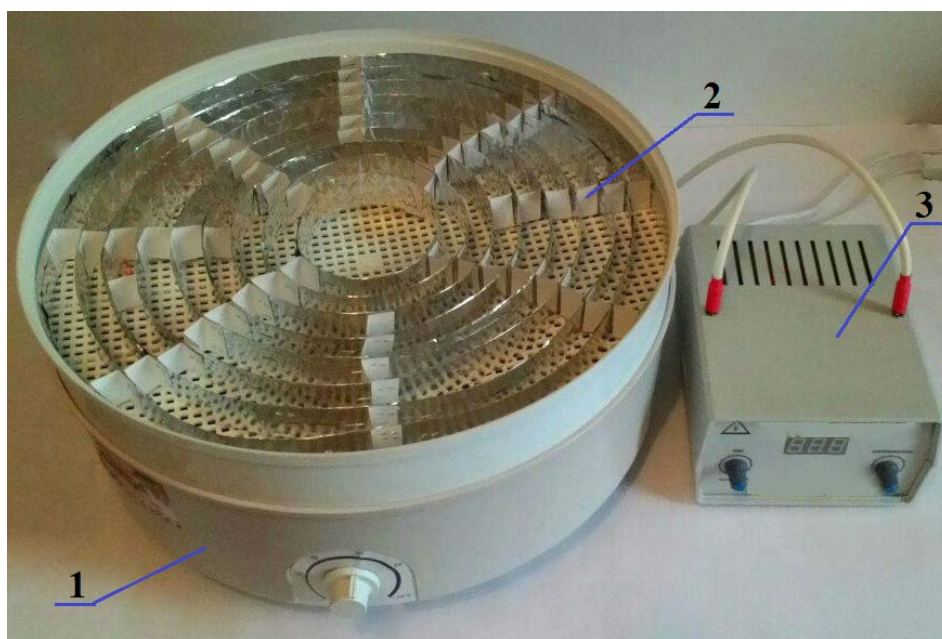
Рис. 1. - Сушилка с блоком электростатической обработки
