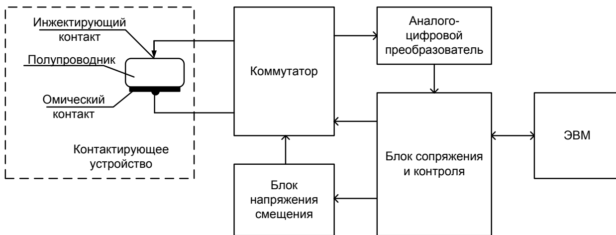
Рис. 3 – Структурная схема подсистемы определения времени жизни неосновных носителей заряда в полупроводниках
