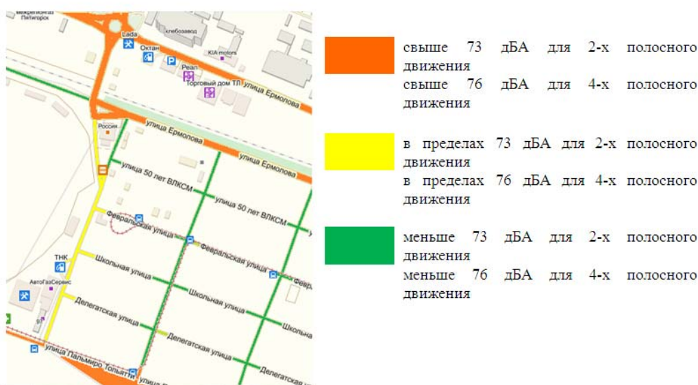
Рис. 1. – Схема и результаты замеров на участке ул. Ермолова и ул. Пальмиро Тольятти
