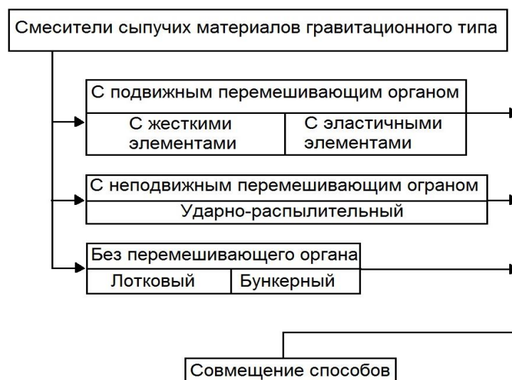
Рис. 1. – Условная классификация по способам смешивания гравитационных аппаратов непрерывного действия для получения сыпучих смесей
