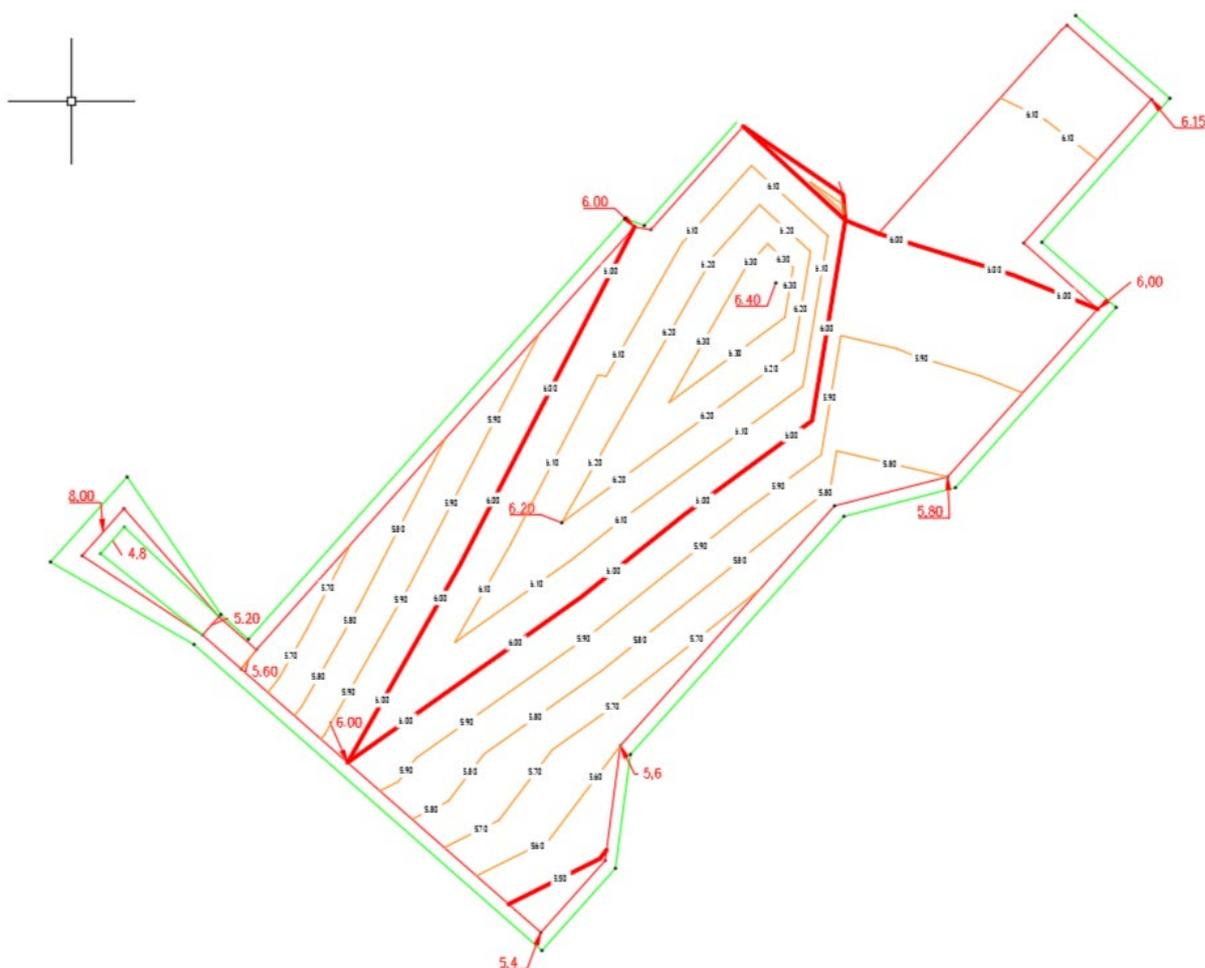
Рис. 2. - Разбивочный чертеж земляных работ кустовой площадки 207
