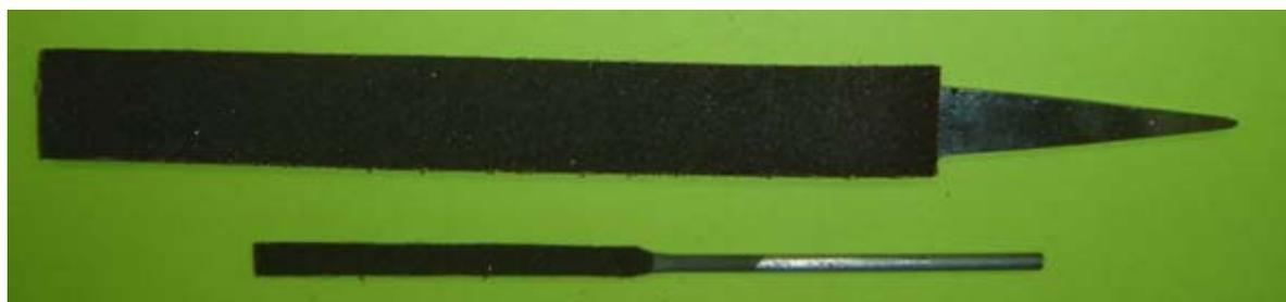
Рис. 6. Опытные образцы напильника и надфиля с рабочей поверхностью, полученной наклеиванием металлизированной абразивной бумаги
