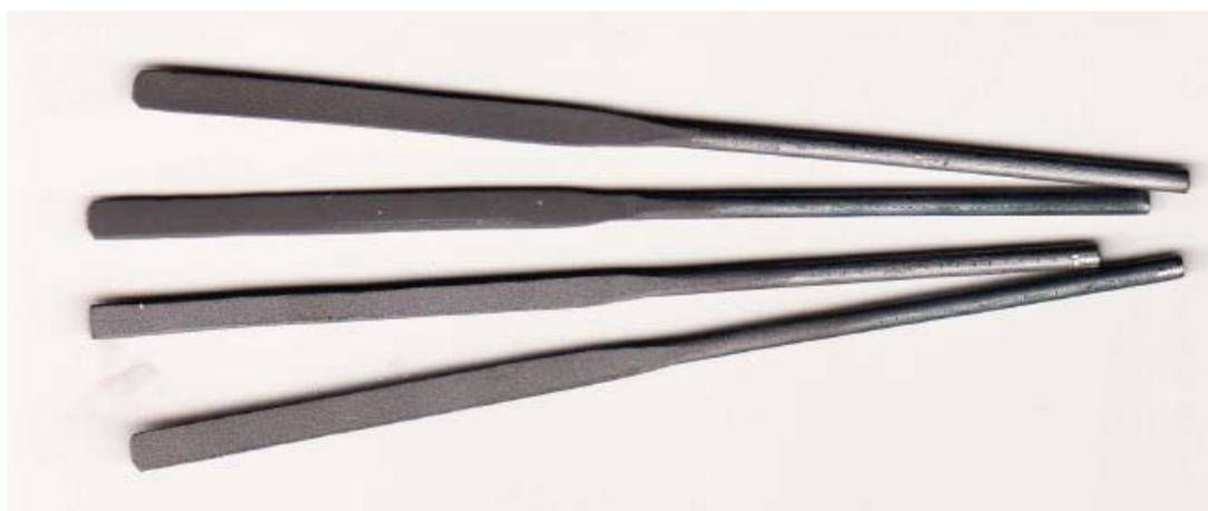
Рис. 2. Образцы надфилей с абразивным твердосплавным покрытием.
