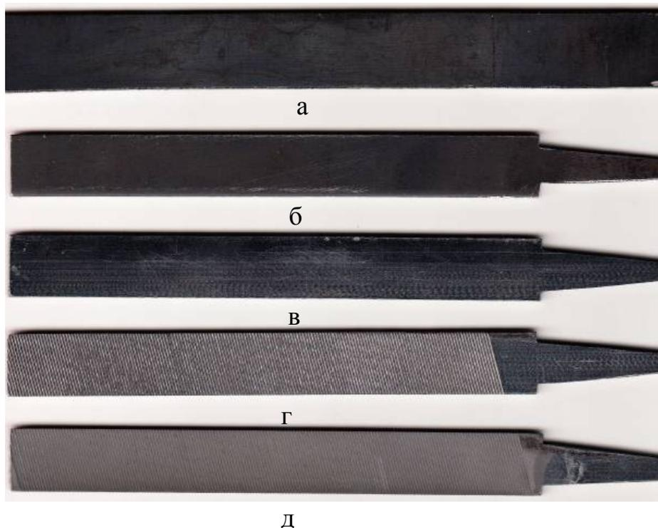
Рис. 5. Стадии изготовления напильника: а – стальная полоса; б – обрезка полосы; в – шлифование заготовки в требуемый размер; г – формирование зубьев; д – детонационное напыление твердого сплава.
