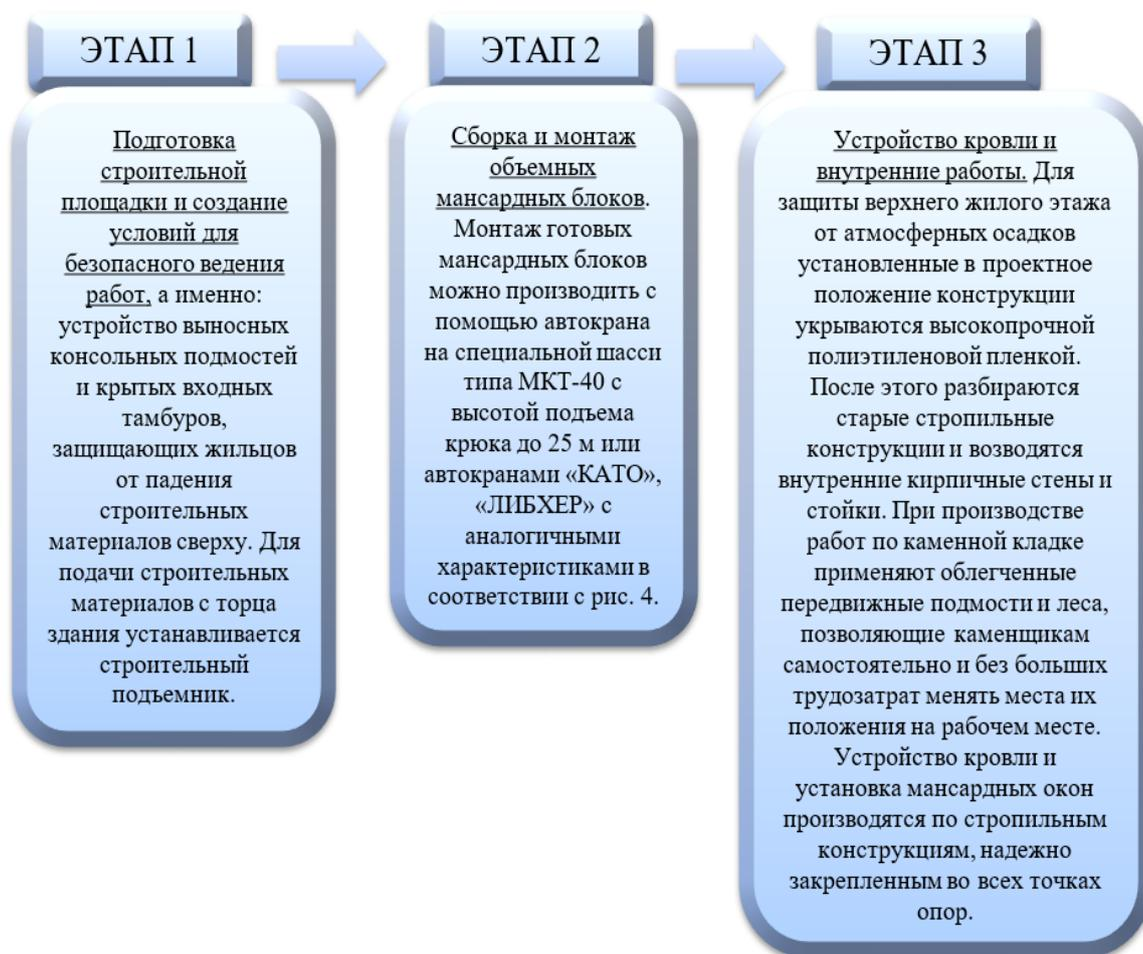
Рис. 3. – Этапы производства работ по устройству мансарды при реконструкции здания (авторская разработка на основе конструктивной системы и технологии, предлагаемой в [15])
