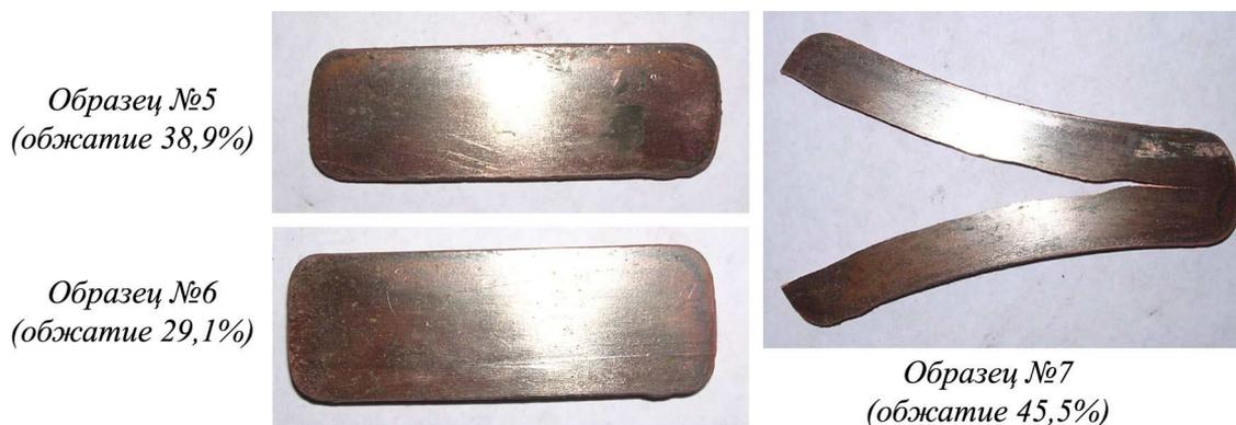
Рис. 4. – Экспериментальная прокатка №5 ... №7
