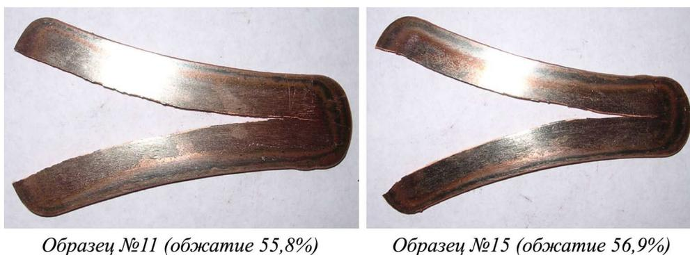
Рис. 6. – Экспериментальная прокатка образцов №11 и №15
