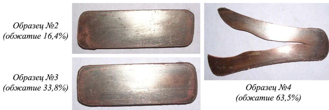
Рис. 3. – Экспериментальная прокатка №2 ... №4
