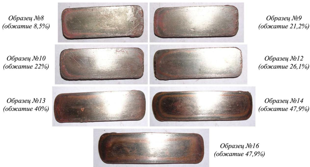
Рис. 5. – Экспериментальная прокатка №8 ... №16
