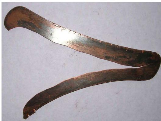
Рис. 2. – Экспериментальная прокатка №1 (обжатие 71,4%)
