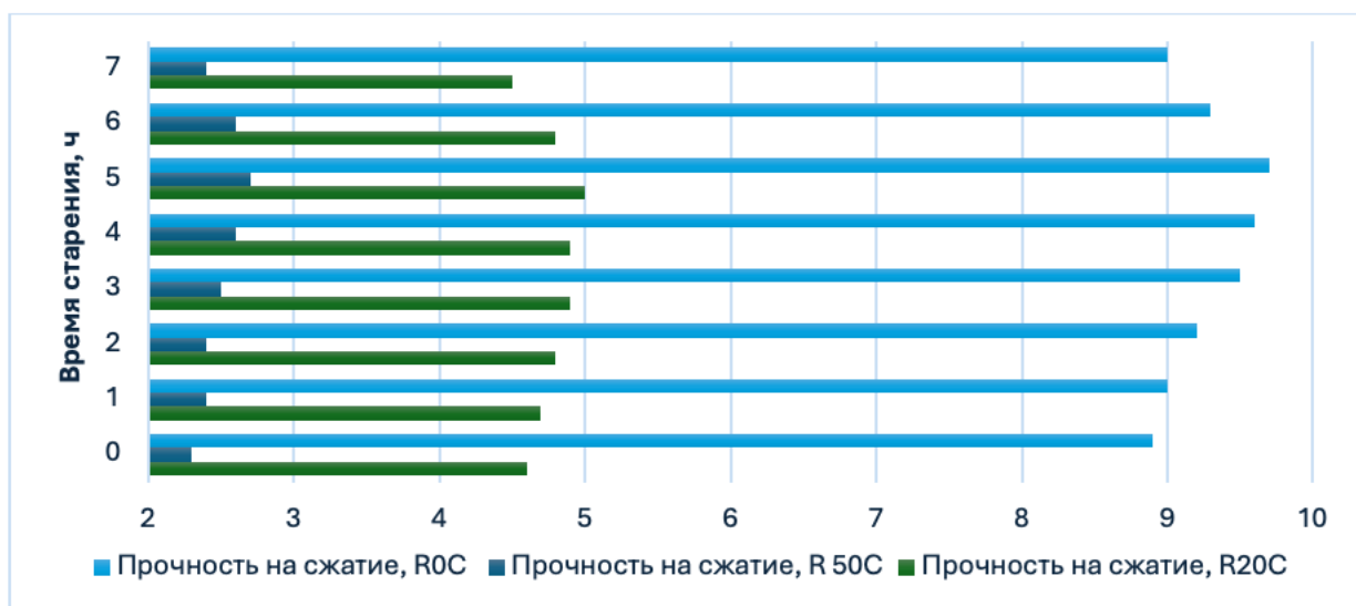
Рис. 2. – Обобщенная зависимость показателя прочности при сжатии и коэффициента старения от времени старения БМС на основе ОПК с модулем крупности заполнителя крупным 2,82
