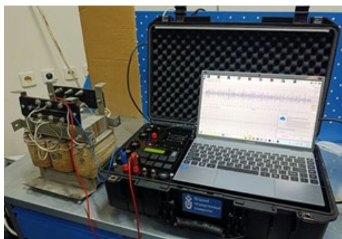
Рис. 1. – Программно-аппаратный комплекс идентификации параметров электрооборудования ПАК-ИП10
