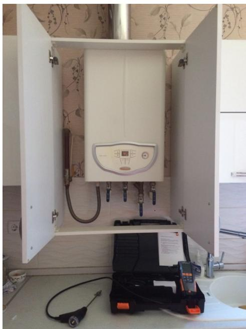
Рис. 1. - Анализатор дымовых газов
