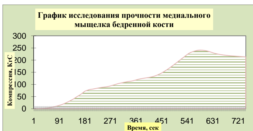
Рис. 3. График прочности кости в режиме разрушающей компрессии на ИСС/М- Scaime ZF-500. По вертикали компрессия в Кгс, по горизонтали время компрессии.
