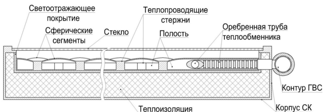
Рис. 3 – Устройство гелиоустановки с независимым контуром нагрева
