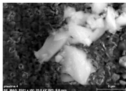
Рис. 2. Скопление кристаллов на катодном покрытии  $MnO_2$ , увеличение 8501x
