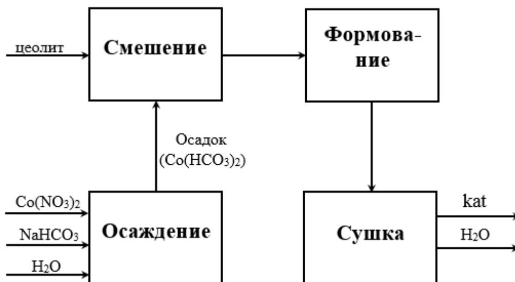
Рис. 1 – Схема приготовления смешанных катализаторов
