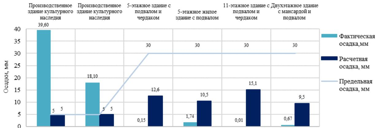
Рис. 4 – Значения фактических, расчетных и предельных осадок зданий, входящих в зону влияния нового строительства
