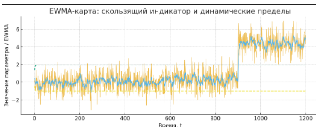
Рис. 3. – EWMA-карта — динамические контрольные пределы, отражающие постепенный рост и скачок
