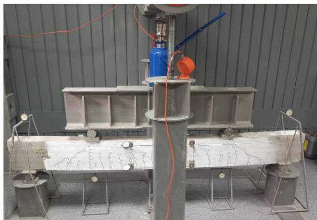
Рис. 2. - Испытание железобетонной балки на изгиб
