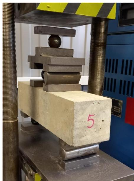
Рис. 1. - Схема устройств и испытания на растяжение при изгибе призмы
