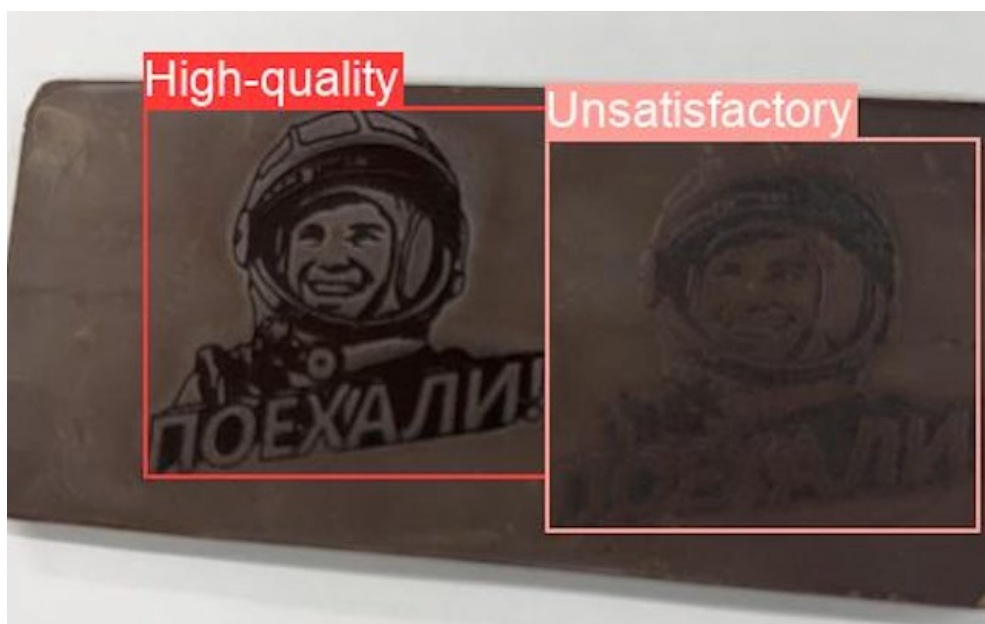
Рис. 4. — Демонстрация работы модуля машинного зрения: классификация участков лазерной гравировки на «Высокое качество» и «Неудовлетворительно».
