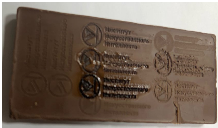
Рис. 1 - Пример дефектов лазерной гравировки шоколадного изделия при некорректной настройке параметров: размытость контура и локальный прожог поверхности.
