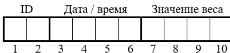
Рис. 3. – Формат массива байт, содержащий показания весового индикатора после конвертации
